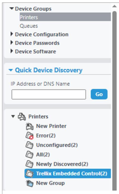
El programa CentreWare Web puede detectar automáticamente dispositivos compatibles con el Control integrado de Trellix y añadirlos a un grupo integrado denominado Control integrado de Trellix.
