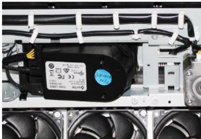
El espectrofotómetro en línea X-Rite® automatiza la recopilación de datos XRGA para calibración y creación de perfiles.
