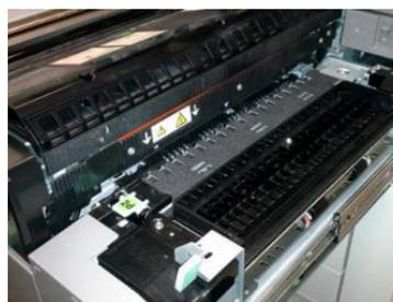
Reductor de curvatura del motor de impresión
