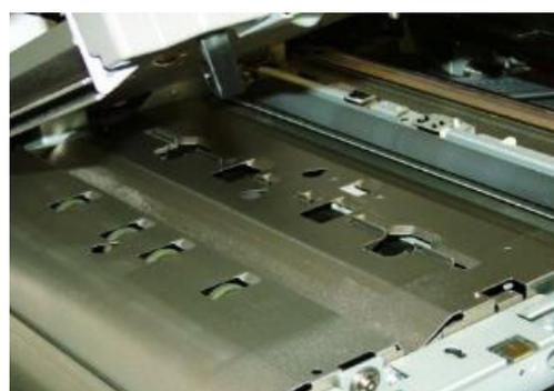
La entrada del registro endereza el papel y posteriormente desciende conforme la página avanza hacia el sensor de imagen de contacto para la realización de ajustes adicionales.
